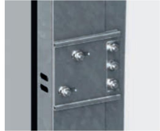
**Geschraubte Verbindung der Zarge mit der Führungsschiene** – wird mittels Montagebleche realisiert. Dank dieser Lösung ist es möglich, die Distanz der vertikalen Führungen einzustellen (Einstellung auf speziellen Bohrungen). Dadurch besteht die Möglichkeit, nur die Führungsschienen auszutauschen. Die Führungsschienen und Zargen werden werkseitig miteinander verschraubt.
