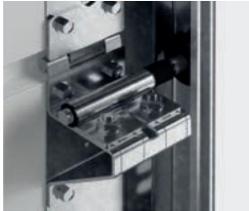
**Leise Führungsrollen** – Die vergrößerten Führungsrollenhalter sind mit speziellen Hülsen aus selbstschmierendem Kunststoff ausgestattet. Dank einer solchen Lösung konnte die Betriebskultur des Tores durch die Beruhigung und Unterdrückung der Vibrationen der Konstruktion erheblich verbessert werden.
